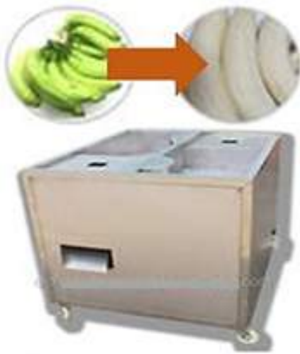
Un éplucheur industriel pour banane verte capable de traiter 600 unités par heure.
