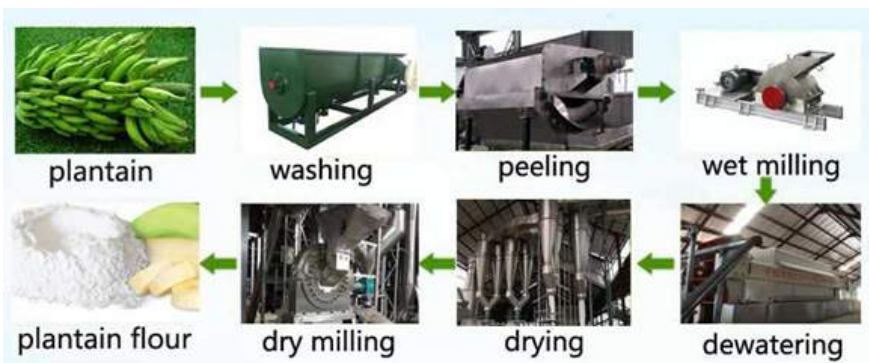
Etapes de la production industrielle de farine depuis le plantain (Crédits: Kaifeng Sida) (PLANTAIN-LAVER-PELER-ECRASER-ESSORER-SECHER-MOUDRE-FARINE DE PLANTAIN)
