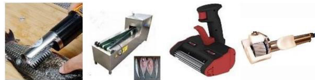
Gamme d'outils de transformation du poisson (de gauche à droite) : écailleur, coupeur, écorcheur et désosseur
