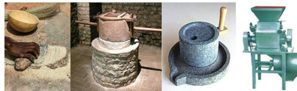
Évolution de la mouture de la farine locale : meule africaine traditionnelle (à gauche), ancien moulin romain en pierre (au centre à gauche), moulin domestique moderne en pierre (au centre à droite), petit moulin électrique (à droite)
