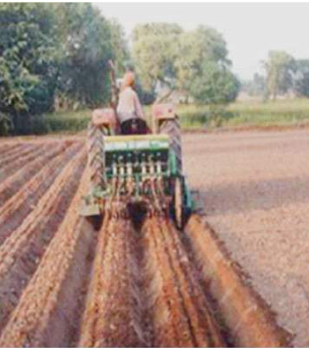
Mise en place de lits, de sillons et de rangées de plantation en un seul passage du tracteur sur un champ bien labouré et nivelé
