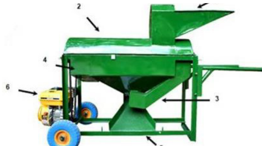
La batteuse Imara Tech Multi-crop se compose d'une 1) goulotte d'alimentation, 2) chambre de battage, 3) goulotte de sortie, 4) souffleur, 5) goulotte de collecte des graines, et 6) moteur à essence
