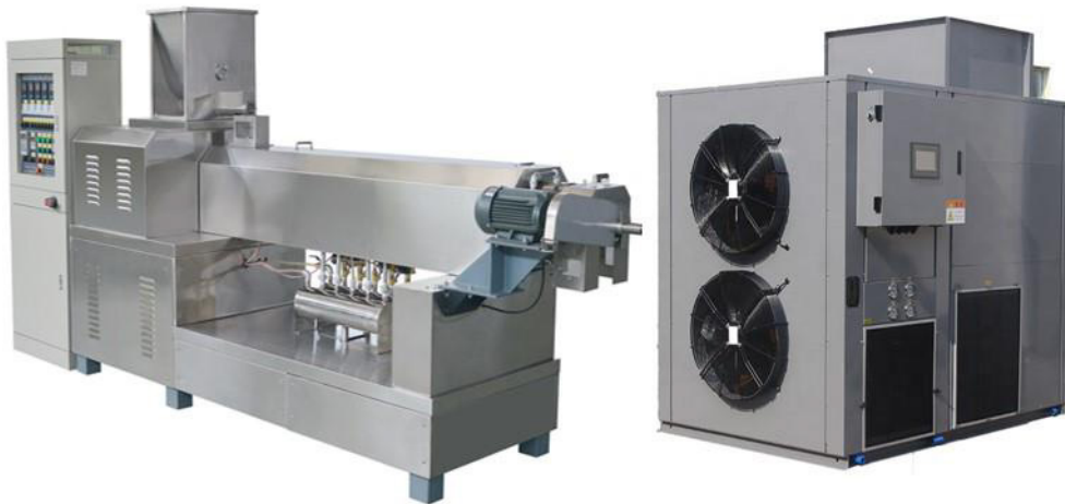
Un rouleau et un coupeur de pâtes à l'échelle industrielle (à gauche) et un four de séchage (à droite).
