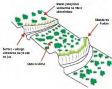
Kielelezo cha 7. Shamba lenye mteremko na matuta yaliyojengwa nakuimarishwa kwa nyasi za malisho. Chanzo: Kihara et al., 2022.
